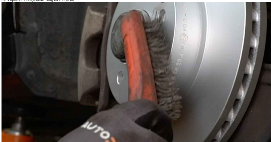
26 Behandle overfladen hvor bremsekiven har kontaktflade til hjulnavet. Brug keramisk fedt.
