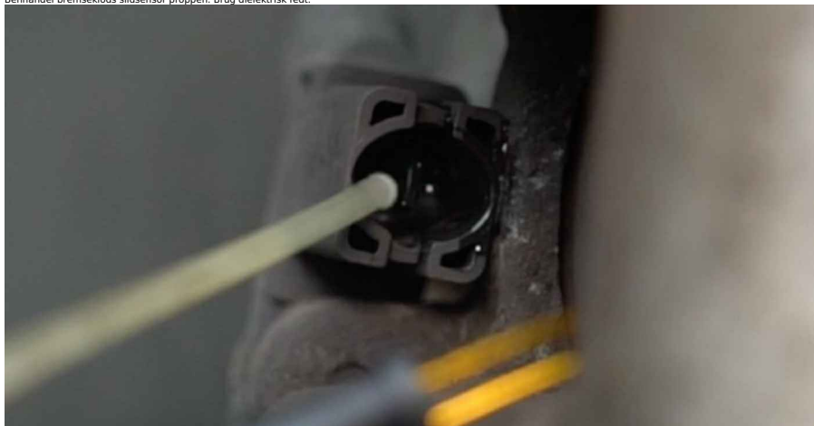
24 Isæt stikket til bremseklods slidensensoren.
