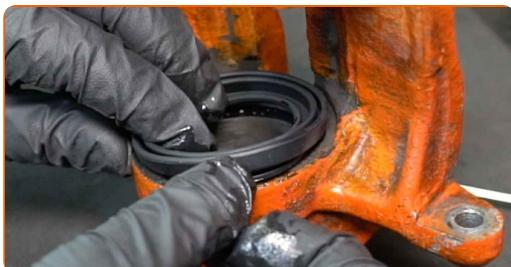
Udskiftning: bremsekaliber reparationssæt – MERCEDES-BENZ E-klasse Coupe (C124). AUTODOC eksperter anbefaler:
