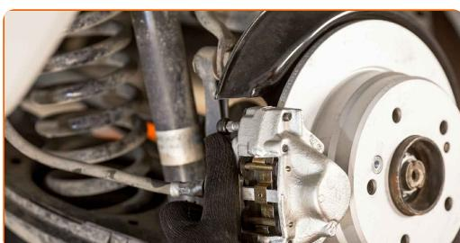
Udskiftning: bremsekaliber – MERCEDES-BENZ E-klasse Coupe (C124).
