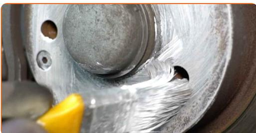
**17** Rengør bremseskivens overflade. Brug bremsrens.
