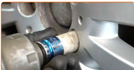
**20** Sænk bilen og stram hjulboltene på kryds med. Brug hjul slagnøgle #17. Brug en momentnøgle. Stram den til 130 Nm moment.
