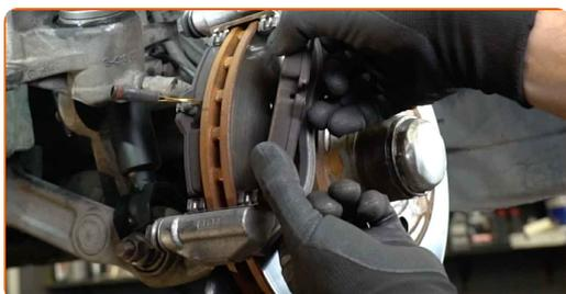
**Udskiftning: bremseklodser – MERCEDES-BENZ E-klasse Ladvogn / Chassis (VF211). Råd fra AUTODOC:**
