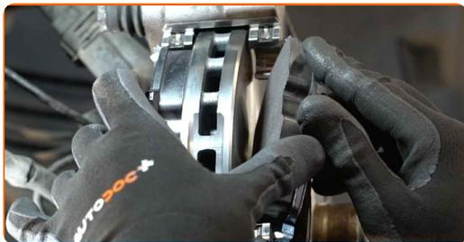
Udskiftning: bremseklodser – MERCEDES-BENZ E-klasse Ladvogn / Chassis (VF211). AUTODOC anbefaler:
