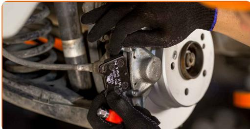
**11** Klem bremseslangen af ved brug af en bremseslange klemme.
