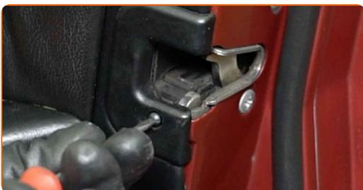
**36** Stram dørpanelets fastgørelsesanordning til. Brug en topnøgle №10. Brug en momentnøgle. Stram den til 8 Nm moment.
