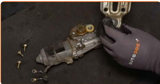
**20** Monter motorens fastgørelser på den nye reguleringsmekanisme og skru dem ind. Brug en topnøgle N°10. Brug en momentnøgle. Stram den til 8 Nm moment.
