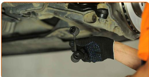
**11** Stram befæstigelsen der forbinder krængningsstabilisatoren med bæreamen. Brug et koben. Brug Torx T50. Brug en momentnøgle. Stram den til 80 Nm moment.
