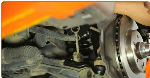
**9** Rengør montagesteder til stabilisatorstangen. Brug en stålbørste. Brug WD-40 spray.
