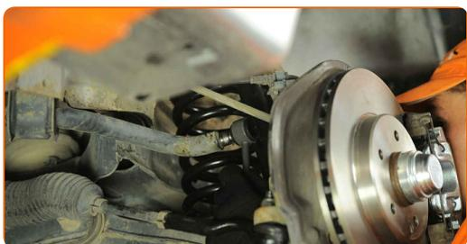
**12** Behandle alle samlinger af krængningsstabilisatoren. Brug kobberfedt.
