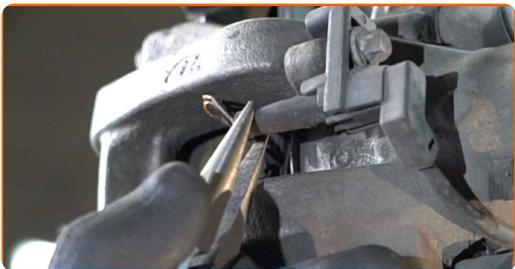
**10** Fjern støvhætter på bremsekaliberens styretapper. Brug et koben.
