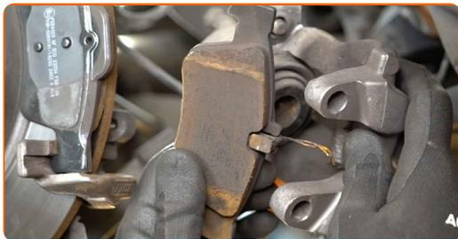
Udskiftning: bremseklodser – MERCEDES-BENZ E-klasse T-modell (S211). Råd fra AUTODOC eksperter:
