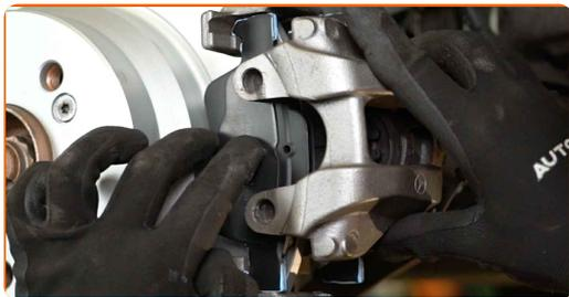
**24** Monter støvhætter på bremsekaliberens styretapper.
