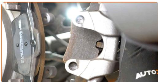
**Udskiftning: bremseklodser – MERCEDES-BENZ E-klasse T-modell (S211).
