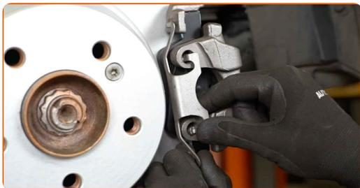
**26** Tilslut bremseklodsernes slidsensor.
