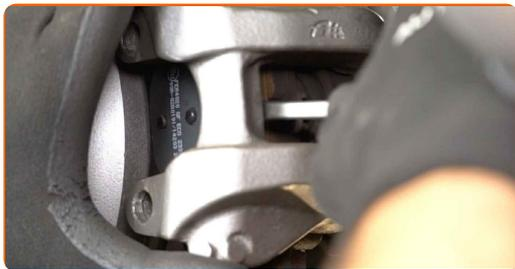
**14** Fjern bremsekaliberen.
