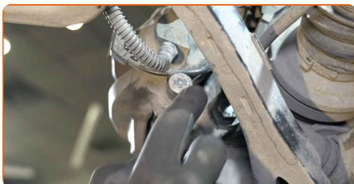
**25** Monter bremsekaliberens holdefjeder.
