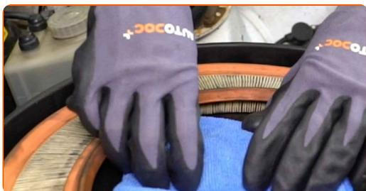
**6** Fjern filterelementet fra filterhuset.
