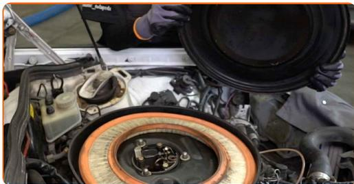
**5** Tildæk luftindsugningslangen med et mikrofiber håndklæde for at undgå at støv og skidt kommer ind i systemet.
