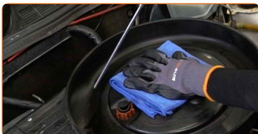
**8** Indsæt et nyt filterelement i filterhuset.
