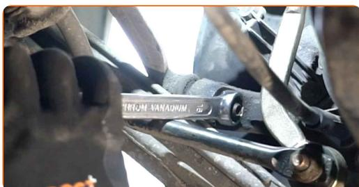
**13** Frigør kugleledet fra bageste spindel. Brug en lejeaftrækker.
