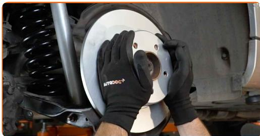
20 Stram bremseskivens skruer. Brug Torx T30. Brug en momentnøgle. Stram den til 9 Nm moment.
