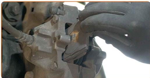
**12** Rengør bremsekaliberens fastgørelser. Brug en stålbørste. Brug WD-40 spray.
