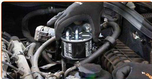
Udskiftning: brændstoffilter – MERCEDES-BENZ SPRINTER 3-t kasse (906).
