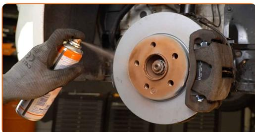
**30** Rengør bremseklodsernes overflade. Brug bremserens.
