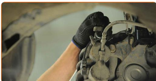
**29** Behandle overfladen hvor bremseklodsen har kontaktflade til hjulnavet. Brug kobberfedt.
