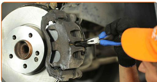
**28** Monter støvhætter på bremsekaliberens styretapper. Brug en skruetrækker med lige kærve.
