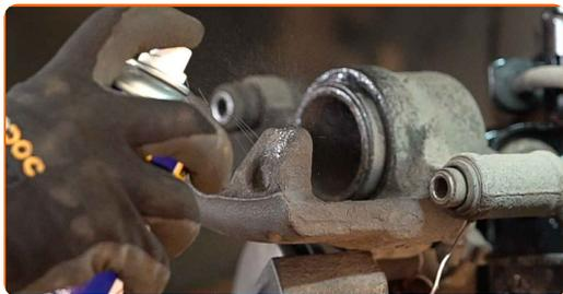
Udskiftning: bremseklodser – MERCEDES-BENZ SPRINTER 3,5-t Bus (906).
