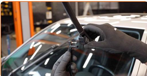
Udskiftning: viskerblade – MERCEDES-BENZ Sprinter 4.6-T Ladvogn/Chassis (906). Råd:
