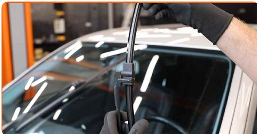
Udskiftning: viskerblade – MERCEDES-BENZ Sprinter 4.6-T Ladvogn/Chassis (906). AUTODOC eksperter anbefaler:
