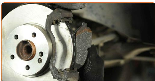
**15** Rengør bremsekaliberen befæstigelse. Brug en stålbørste. Brug WD-40 spray.
