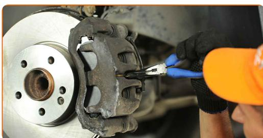
**36** Monter støvhætter på bremsekaliberens styretapper. Brug en skruetrækker med lige kærvt.
