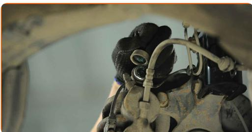
**8** Tag bremseklodsens slidensors stik af. Brug rundtænger.
