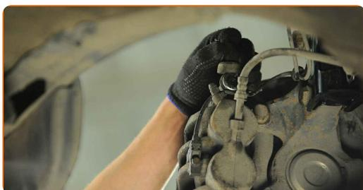
**37** Behandle overfladen hvor bremseeskiven har kontaktflade til hjulnavet. Brug kobberfedt.
