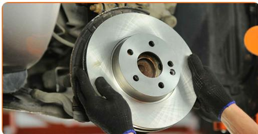
**23** Stram bremseskivens skruer. Brug Torx T30. Brug en momentnøgle. Stram den til 18 Nm moment.
