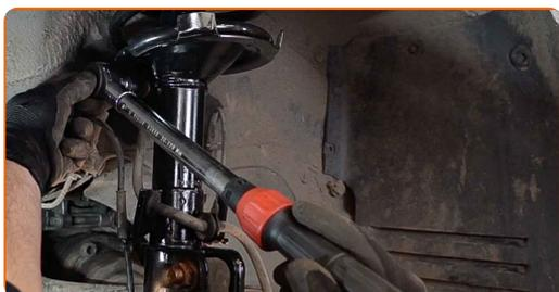
**12** Spænd befæstigelsen til der forbinder forbindelsesstangen med krængningsstabilisatoren. Brug en topnøgle N°16. Brug en kombinøgle N° 16. Brug en momentnøgle. Stram den til 62 Nm moment.
