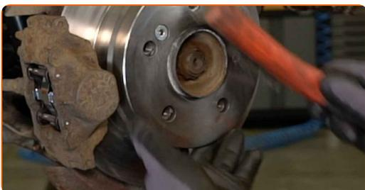
**45** Behandle overfladen hvor bremsekiven har kontaktflade til hjulnavet. Brug keramisk fedt.
