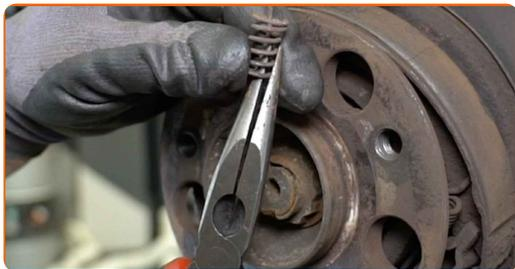
**23** Fjern parkeringsbremsens justeringsanordning.
