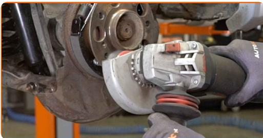
**33** Behandel kontaktfladen. Brug keramisk fedt.
