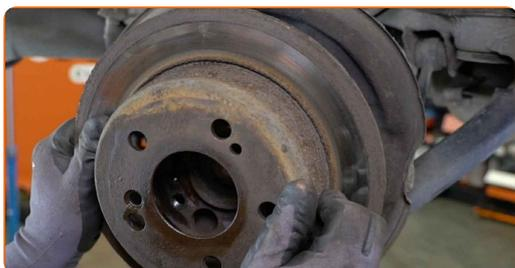
**21** Fjern returfjederen på øverste bremsebakke. Brug et koben.
