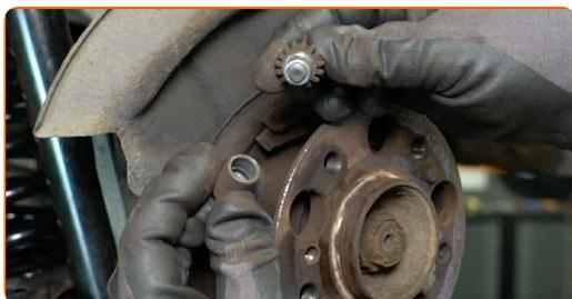
**24** Fjern den nederste returfeder på bremseskoen. Brug en skruetrækker med lige kær. (Note: The text says 'skruetrækker' but the image shows a screwdriver being used to pry a spring.)
