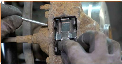
**43** Installer bremseklodsernes styrestifter. Brug en drivdorn. Brug en hammer.
