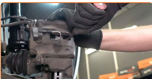
**13** Rengør bremsekalibren befæstigelse. Brug en stålbørste. Brug WD-40 spray.
