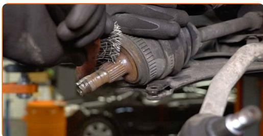
**44** Monter styrekuglen med et nav i samlingen. Monter kardanaksel.
