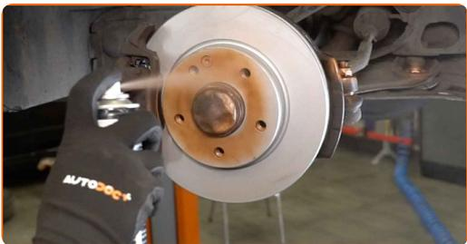
**71** Rengør bremseskivens overflade. Brug bremsrens.
