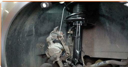
**16** Rengør bremsekive befæstigelse. Brug en stålbørste. Brug WD-40 spray.
