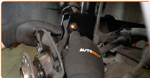
**50** Skru befæstigelserne ind der forbinder fjederbenet med styrespindlen. Brug en kombinøgle N° 18. Brug en topnøgle N°18. Brug en skraldenøgle.
