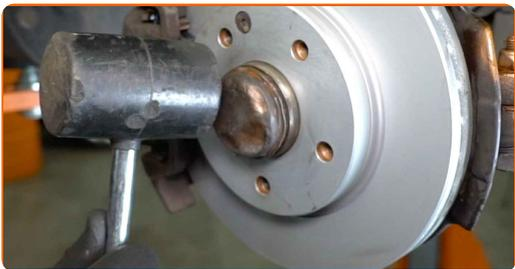
**70** Behandle overfladen hvor bremseskiven har kontaktflade til hjulnavet. Brug kobberfedt.
