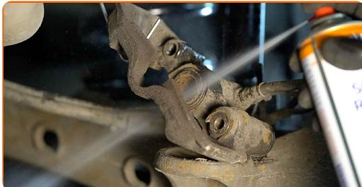
Udskiftning: bremseklodser – MERCEDES-BENZ Vito Van (W638). AUTODOC eksperter anbefaler:
