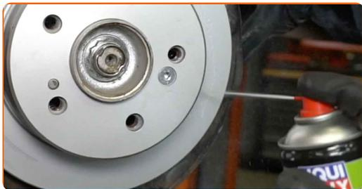
**35** Behandle overfladen hvor bremseskiven har kontaktflade til hjulnavet. Brug keramisk fedt.
