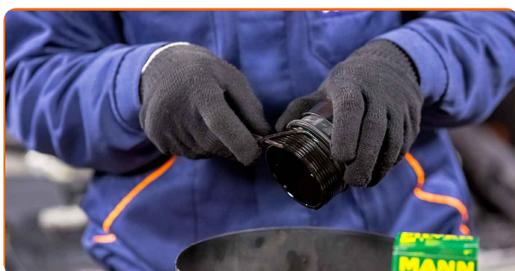
9 Rengør oliefilter hættten. Brug universal rengøringsmiddel.
