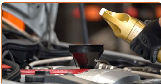
Udskiftning: olie og oliefilter – MERCEDES-BENZ W124 Coupe (C124).
