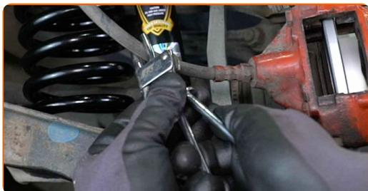
**14** Rengør montagesædet for bremseslangen på bremsekaliberen. Brug en stålbørste. Brug WD-40 spray.
