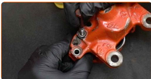
**38** Stram de fastgørelser, der forbinder de to dele af kaliberen, til. Brug en topnøgle N°14. Brug en momentnøgle. Stram den til 35 Nm moment.
