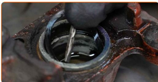
**30** Rengør moteringssæderne til stemplerne og de tilhørende komponenter. Brug en stålbørste. Brug en nylon rengøringsbørste. Brug universal rengøringsmiddel.
