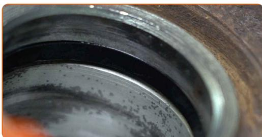
**32** Monter støvmanchetter på de nye bremsekaliberstempler.
