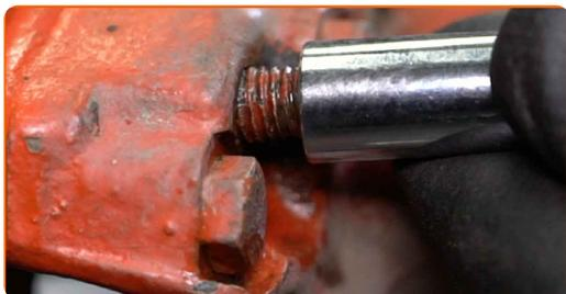
**23** Skru de skruer af, der forbinder de to dele af bremsekaliberen. Brug en topnøgle №14. Brug en skraldenøgle.
