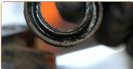
**28** Fjern bremsekaliberstemplerne. Brug vandpumpe tænger.
