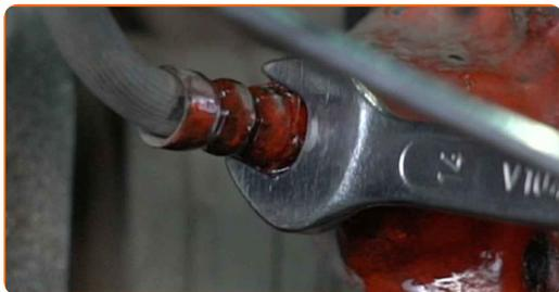
**16** Rengør bremsekaliberens fastgørelser. Brug en stålbørste. Brug WD-40 spray.
