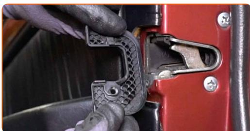
**4** Frigør dørhåndtagets beklædningspanel. Brug en plastik klipsptang.
