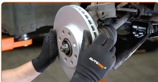
**21** Stram bremseskivens skruer. Brug Torx T30. Brug en momentnøgle. Stram den til 8 Nm moment.
