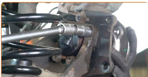
**31** Stram navlejets møtrikker til. Brug en topnøgle №16. Brug en momentnøgle. Stram den til 50 Nm moment.+45°
