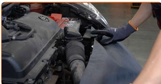
**3** Frakoble befæstigelsen til luftindsugningsslangen. Brug et panelclip værktøj.
