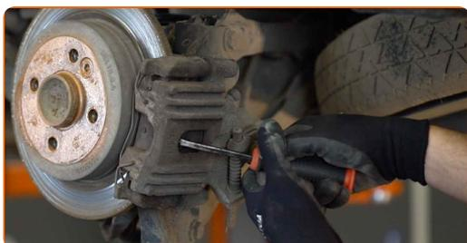
8 Fjern støvhætter på bremsekaliberens styretapper.
