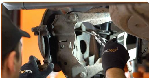
16 Skru bremsekivens bolte til beslaget af og fjern dem. Brug Torx T30.
