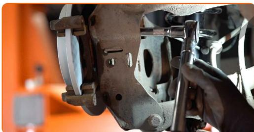
23 Tryk bremsekaliberens stempel ind. Brug bremsestempelværktøj.
