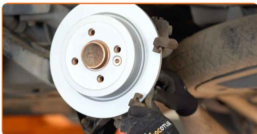
22 Stram bremsekaliberens beslag. Brug en topnøgle N°16. Brug en momentnøgle. Stram den til 65 Nm moment.
