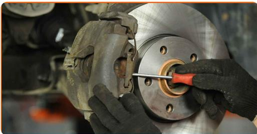
**8** Fjern støvhætter på bremsekaliberens styretapper. Brug et koben.
