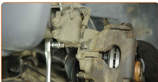
**23** Monter støvhætter på bremsekaliberens styretapper.
