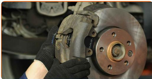
**20** Behandel bremsekaliber styrestifterne. Brug bremsekaliber fedt.
