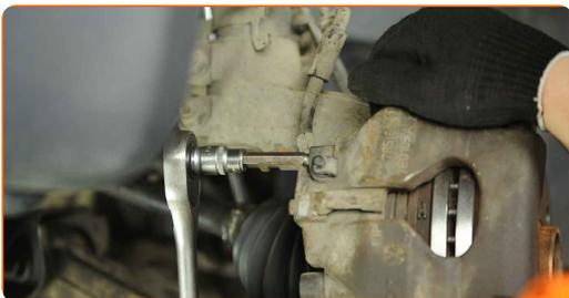
**11** Fjern bremsekaliberens styrepinde.
