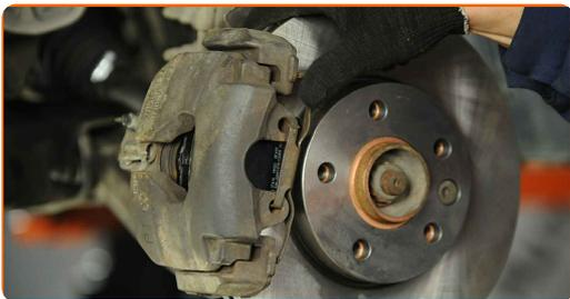
25 Behandle overfladen hvor bremseklodsen har kontaktflade til hjulnavet. Brug keramisk fedt.
