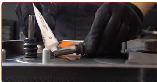
**21** Montér bremsekaliberens styrepinde.
