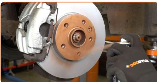
26 Rengør bremseklodsens overflade. Brug bremserens.
