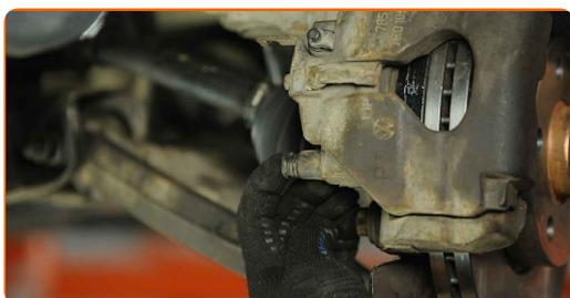
24 Monter bremsekaliberens holdefjeder.
