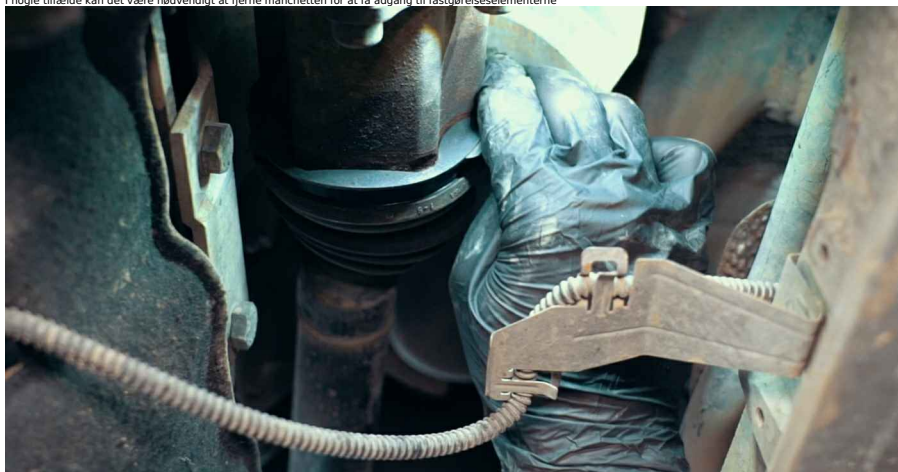
9 I nogle tilfælde kan det være nødvendigt at fjerne manchetten for at få adgang til fastgørelseselementerne
