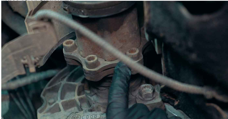
8 Hvis der er en flangemontering, skal boltene skrues ud
