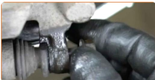
**11** Fjern bremsekaliberen.
