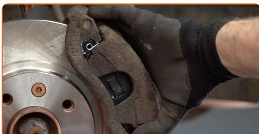
**18** Monter bremsekaliberens holdefjeder.
