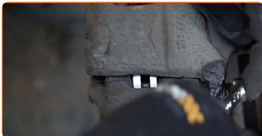
10 Løsgør bremsekaliber låsefjeder. Brug et koben.
