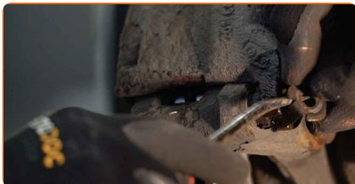
11 Træk bremsekaliberen til side.
