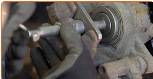
**17** Tilbagefør bremsekaliber enheden i dets oprindelige position. Brug en topnøgle N°13. Brug en momentnøgle. Stram den til 35 Nm moment.
