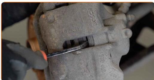
**8** Rengør bremsekaliberens fastgørelser. Brug en stålbørste. Brug WD-40 spray.
