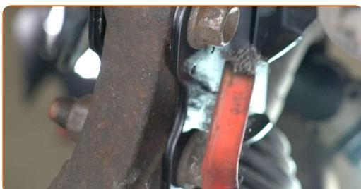
**35** Skru befæstigelserne af der forbinder fjederbenet med styrespindlen. Brug en kombinøgle № 17. Brug en topnøgle №19. Brug en skraldenøgle.
