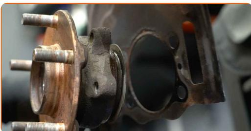
**34** Rengør navlejets monteringsæde. Brug en stålborste.
