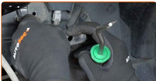
**19** Træk stikket ud til ABS sensor. Brug et panelclip værktøj.
