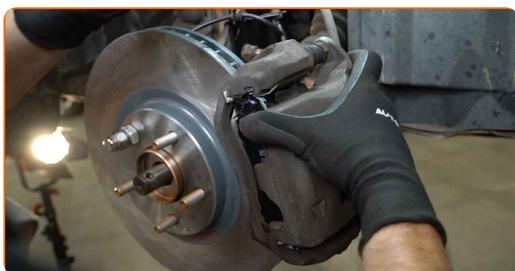
**63** Stram bremsekaliberens beslag. Brug en topnøgle №19. Brug en momentnøgle. Stram den til 152 Nm moment.
