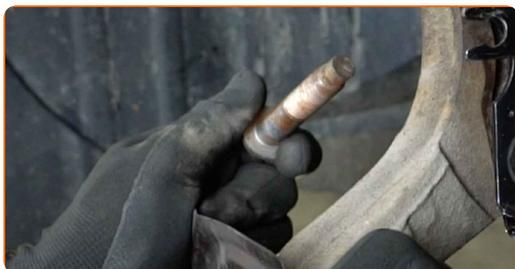
**23** Fjern kardanakslen. Brug en drivdorn. Brug en hammer.
