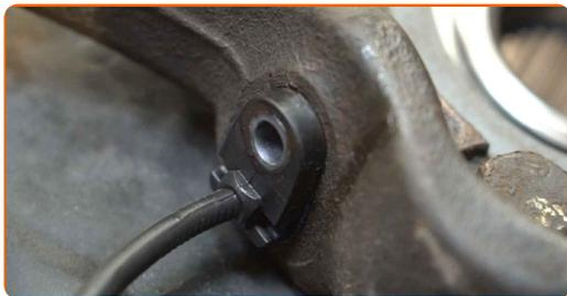
42 Stram befæstigelserne som forbinder ABS sensoren med styrespindlen. Brug en topnøgle N°10. Brug en momentnøgle. Stram den til 13 Nm moment.
