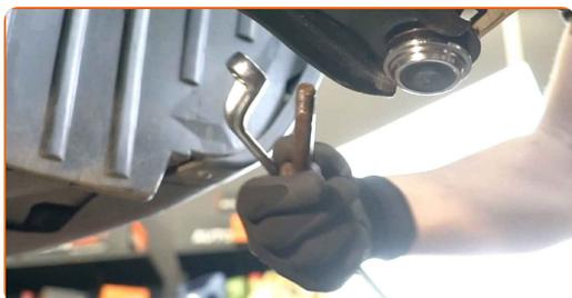
**17** Tag ABS sensorens ledninger af. Brug et panelclip værktøj.
