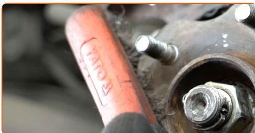
**20** Behandl kontaktfladen. Brug keramisk fedt.
