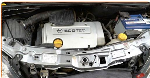
**26** Tjek ved hjælp af oliepinde olieniveauet 5 minutter efter at have slukket motoren, og tilføj mere olie hvis nødvendigt.
