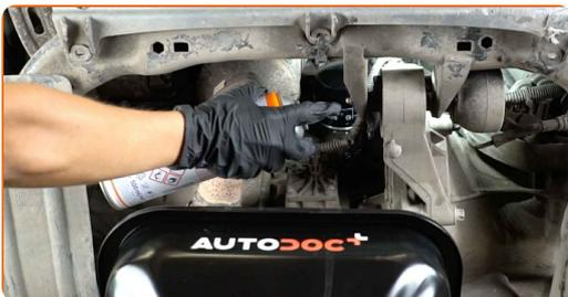
**10** Løsne oliefilter. Brug 76-F14 spændenøgle. Brug en skraldenøgle.
