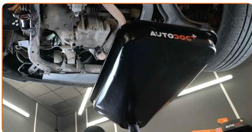
**6** Rengør området omkring udtømningshullet på oliesump. Brug en stålbørste. Brug universal rengøringsmiddel.
