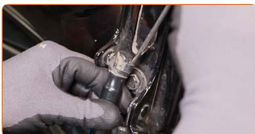
**3** Frigør låseringen der forbinder gasfjederen til karosseriet. Brug en skruetrækker med lige kærv.
