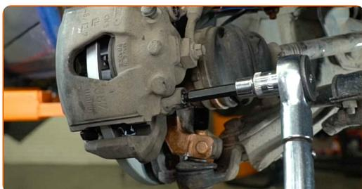
**31** Monter støvhætter på bremsekaliberens styretapper.
