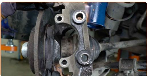
**17** Skru bremsestavens skruer af. Brug en Phillips skruetrækker. Brug en slagskruetrækker.
