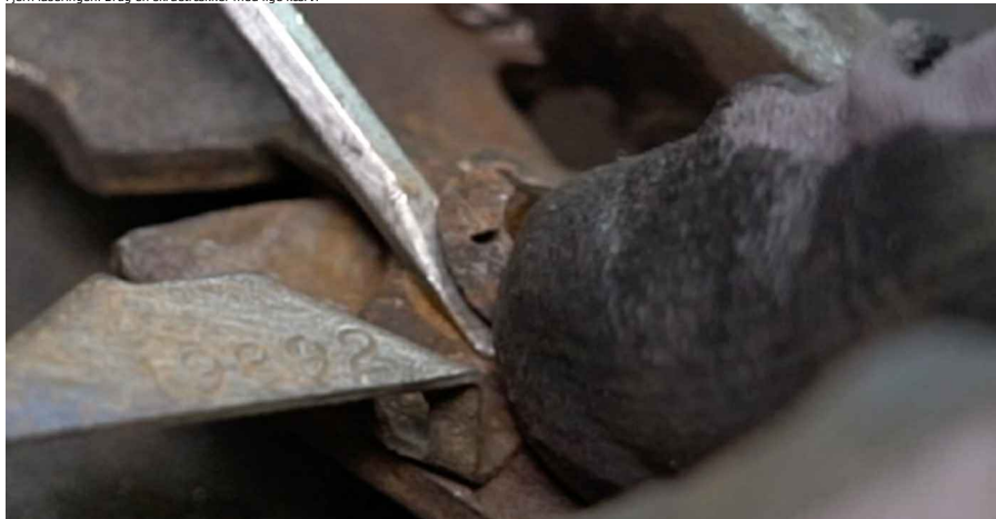
28 Fjern bremseko justeringshåndtaget.
