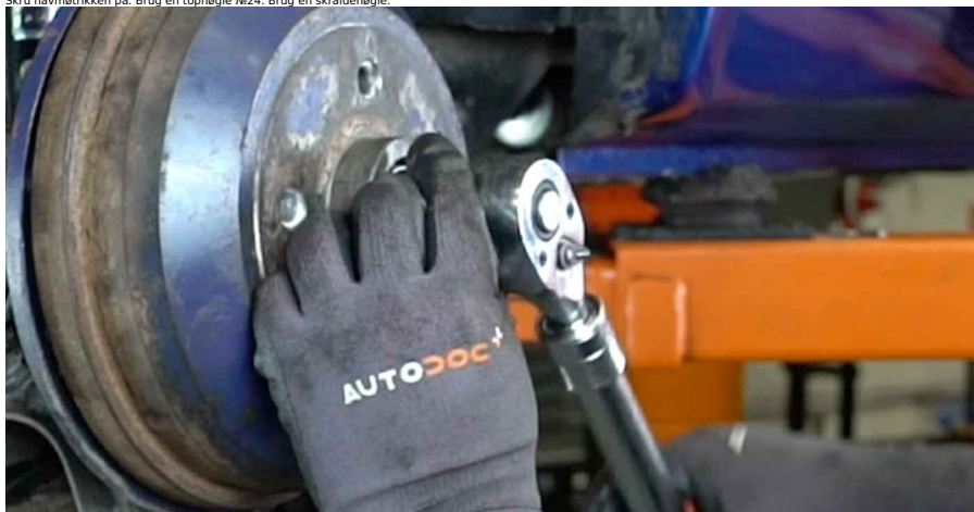
47 Skrú hjulboltene til. Brug hjul slagnøgle #17.
