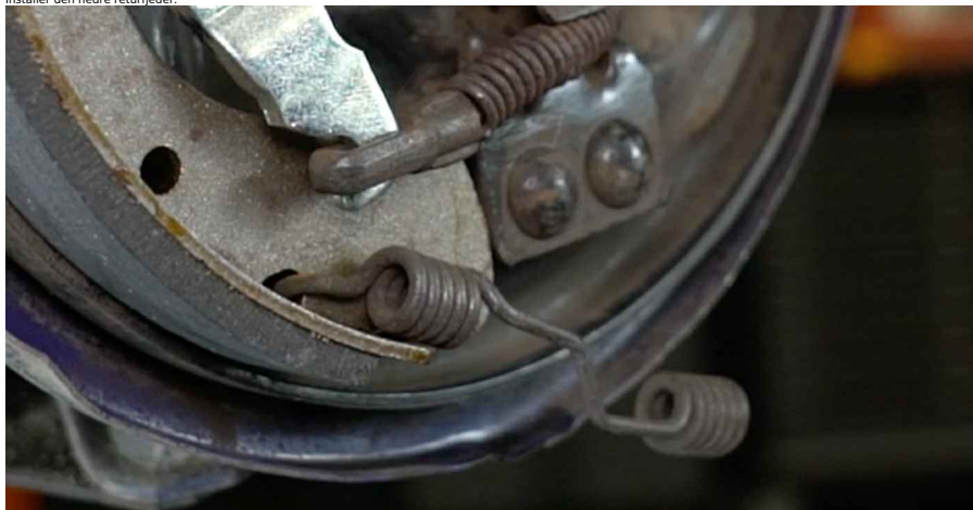
25 Installer den nedre returfeder.
