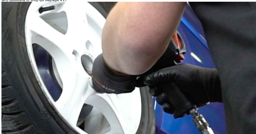
AUTODOC anbefaler: • Advarsel! For at undgå skade, hold på hjulet mens befæstigelses boltene strammes på bilen. OPEL Astra F CC (T92)
