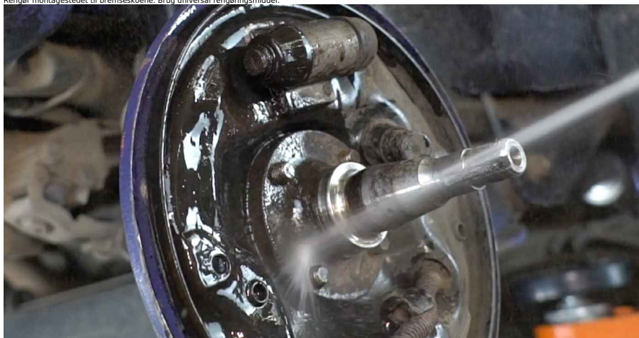
Udskiftning: bremsebakker - OPEL Astra F CC (T92). Råd fra AUTODOC eksperter:
