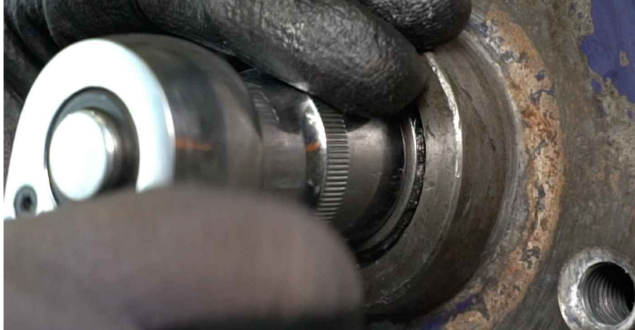
9 Fjern spændeskiven fra hjullejet. Brug et koben.
