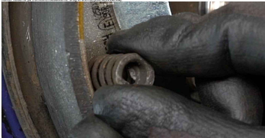
39 Installer nedpresnings fjederen.
