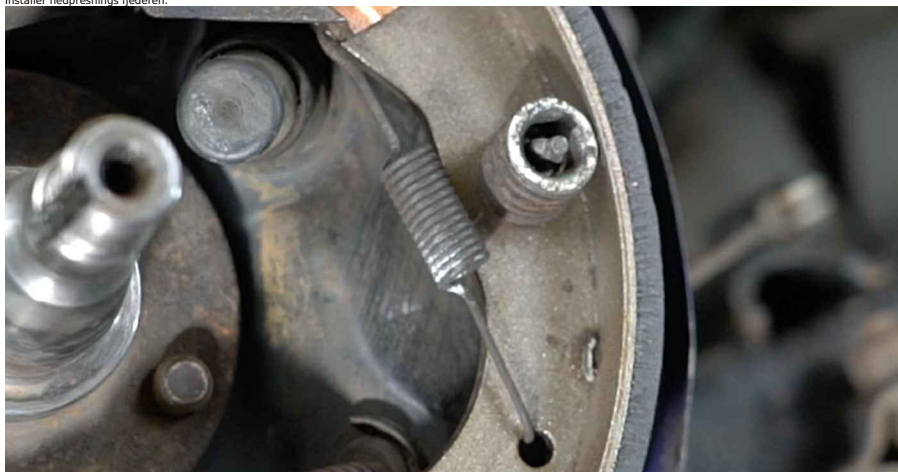
40 Installer den øvre returfeder. Brug spidstænger.
