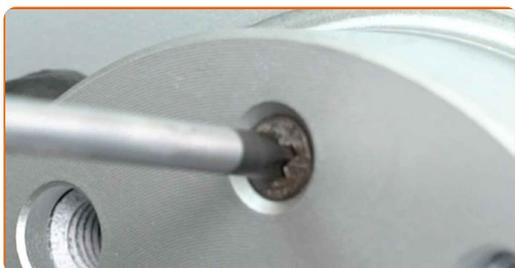
**22** Stram bremseskivens skruer. Brug en Phillips skruetrækker. Brug en momentnøgle. Stram den til 7 Nm moment.
