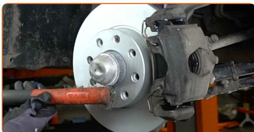
**34** Behandle overfladen hvor bremsekiven har kontaktflade til hjulnavet. Brug varmebestandig keramisk fedt.
