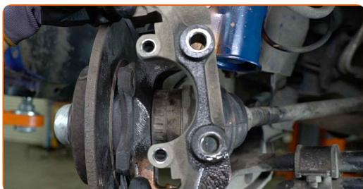
**17** Skru bremseaktivens skruer af. Brug en Phillips skruetrækker. Brug en slagskruetrækker.
