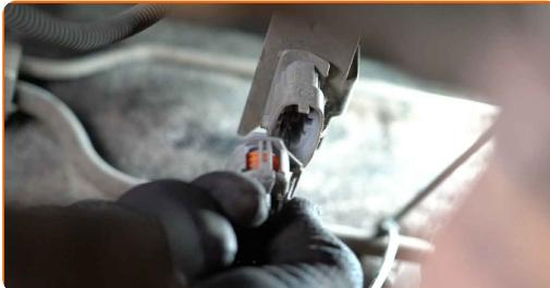
**5** Rengør oxygen sensorens befæstigelse. Brug en stålborste. Brug WD-40 spray.
