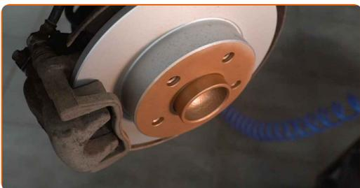
**35** Rengør bremsekivens overflade. Brug bremserens.
