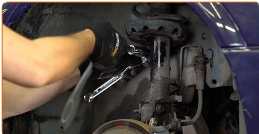
**8** Rens krængningsstabilisatorens befæstigelser. Brug en stålbørste. Brug WD-40 spray.
