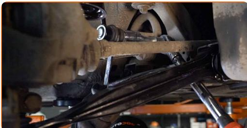
**11.2** Brug en kombinøgle № 19. Brug en topnøgle №18. Brug en momentnøgle. Stram den til 65 Nm moment.
