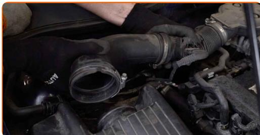
38 Forbind luftindsugningen til luftfilterhuset.
