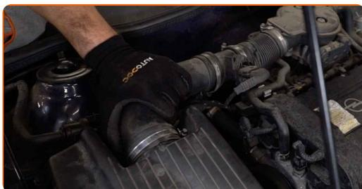
39 Fastgør klammen på luftindsugningsslangen. Brug en topnøgle N°7. Brug en skraldenøgle.
