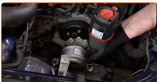
25 Fjern støtten fra under motoren.
