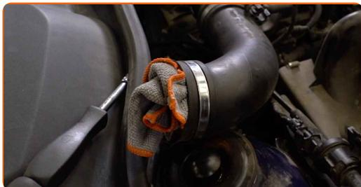
6 Løsen befæstigelse der forbinder luftslangen og ledningsnet til luftfilterkammeret.
