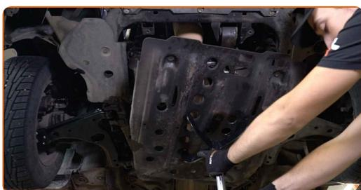
28 Understøt undervogns motorskjoldet. Brug en hydraulisk løfteenhed.
