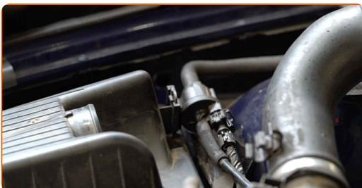
37 Fjern mikrofiber håndklædet fra luftindsugningsslangen.
