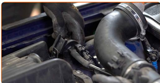
7 Tag filterets låg af. Fjern filterelementet fra filterhuset.
