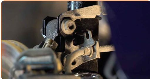
**37** Fastgør stabilisatorforbindelsen på stiveren. Brug en kombinøgle №19. Brug en topnøgle №18. Brug en momentnøgle. Stram den til 65 Nm moment.
