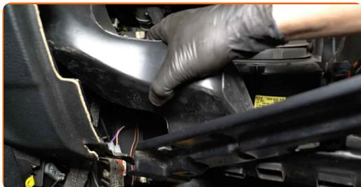
**9** Frigør kabinefilter dækselklemmerne. Brug et panelclip værktøj.
