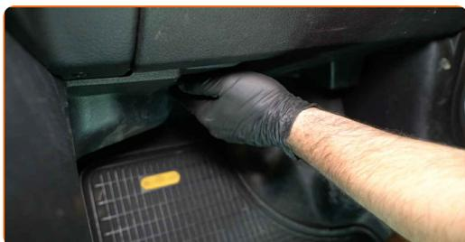
**22** Skru befæstigelse til på bund beklædningspanelet. Brug Torx T20.
