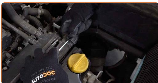
**4** Skru tændspolens beslag af. Brug Torx T30. Brug en skruldøgle.
