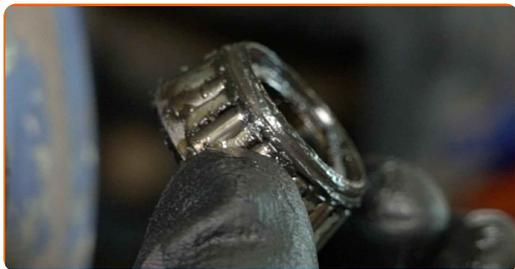
**11** Fjern bremsetromle samling med hjulnavlejet.
