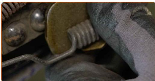
**38** Monter holderne på tromlebremsebakkerne. Brug et bremsefjederskiveværktøj.
