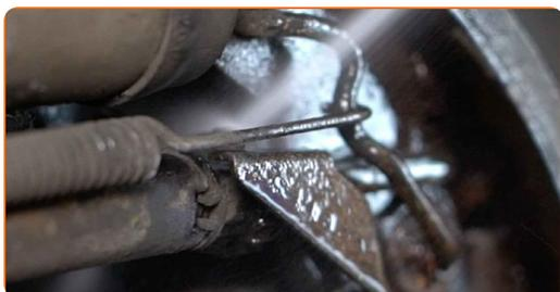
**13** Løsn justeringen til bremseblokken. Brug et koben.
