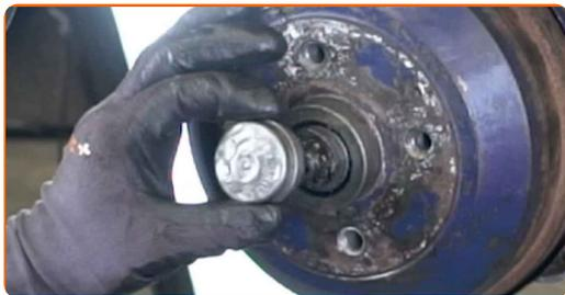
**7** Fjern splitstiften som sikre navmøtrikken. Brug et koben. Brug en skruetrækker med lige kær.
