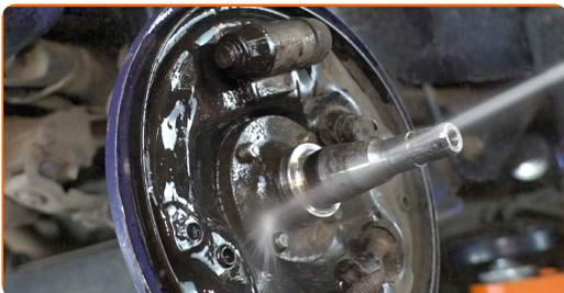
Udskiftning: bremsebakker – OPEL Corsa A CC (S83). Råd fra AUTODOC eksperter:
