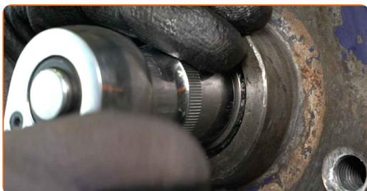
**9** Fjern spændeskiven fra hjullejet. Brug et koben.
