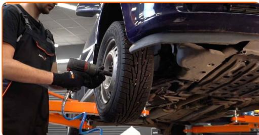
**Udskiftning: stabilisatorbøsning – OPEL Corsa A CC (S83). Råd:**
