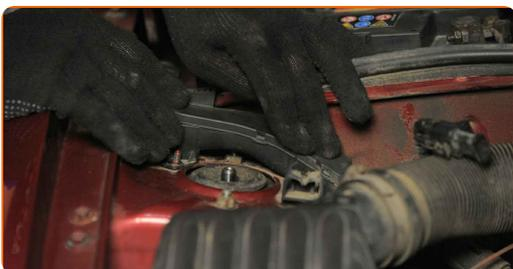
**38** Skru befæstigelse ind på motorens ledningsnet beslaget. Brug en topnøgle №10. Brug en skraldenøgle.
